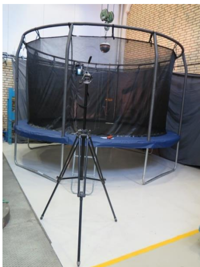
Bild 14 Släpp av provkropp från 2 m
