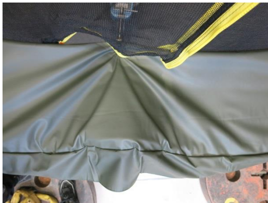
Bild 35 Acon, drag 150N av kantskydd
