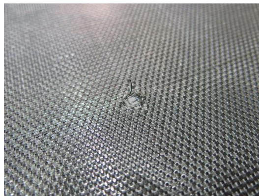
Bild 17 Biltema, hål efter studsprov
