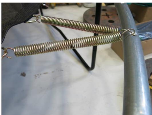
Bild 50 Berg, dubbla fjädrar i ett hål
