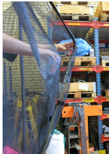
Bild 48 Hudora, Slappt nät skyddar ej mot fall från sidan mot ingång.
