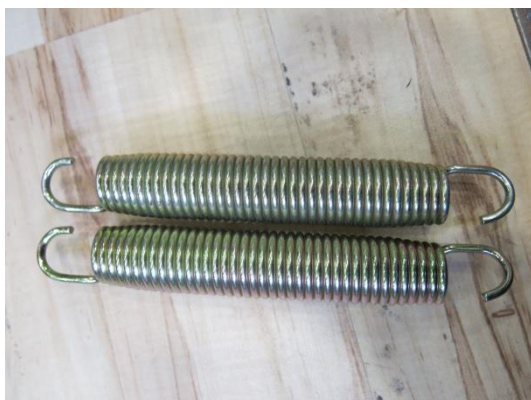
Bild 52 Biltema, fel fjädermodell
