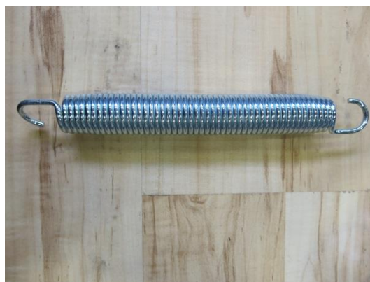
Bild 51 Acon, Fel fjädermodell
