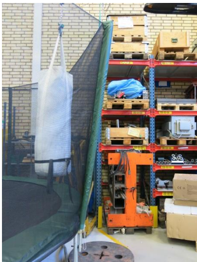
Bild 41 Jysk, Kvarstående deformation på nätstolpe
