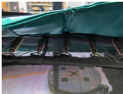
Bild 30 North, extra nät över fjädrarna
