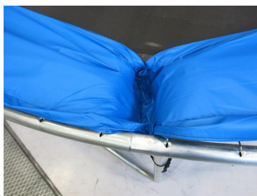
Bild 26 Biltema, kvarstående nedtramp efter genomtrampsprov
