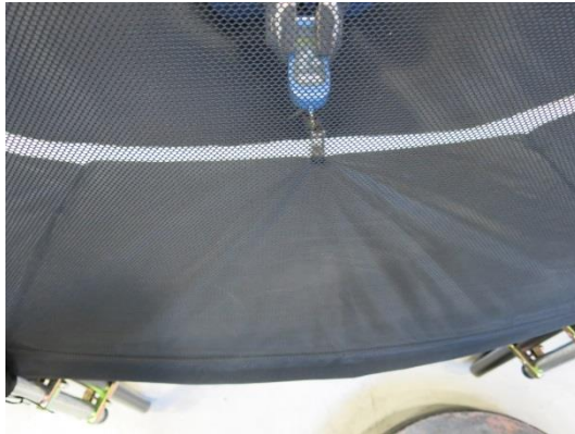
Bild 33 Orbit, drag 150N av kantskydd
