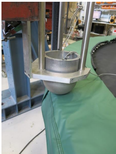
Bild 21 En halvfärisisk fallkropp (4,6 kg) användes vid proverna av stötupptagande förmåga.
