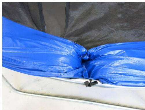
Bild 28 Hudora, kvarstående efter genomtrampsprov
