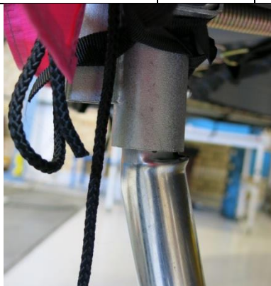
Bild 37 Exit Twist, deformerad ram belastning. vid belastning.
