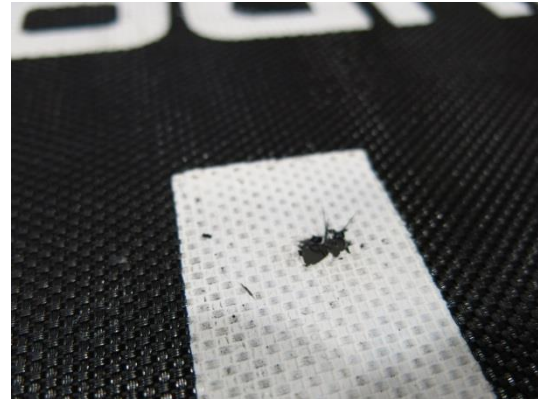
Bild 19 Hudora, hål efter studsprov
