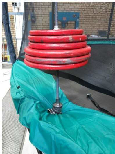
Bild 22 Genomtrampsprov med 100 kg
