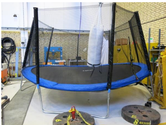
Bild 43 Lyfco, deformation efter slagprov
