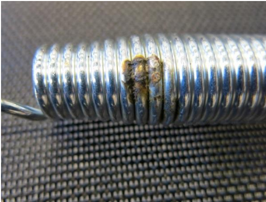
Bild 54 Lyfco, Rostangrepp på fjäder
