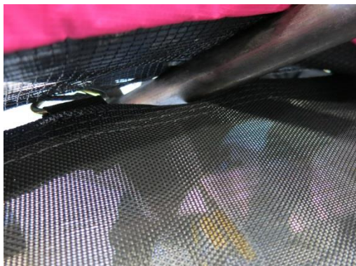
Bild 27 Exit Twist, stora hål mellan matta och kantskyddsnät
