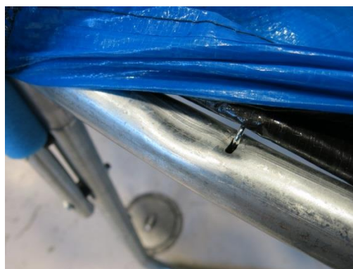
Bild 32 Fly, buckla på ramen efter HIC-test
