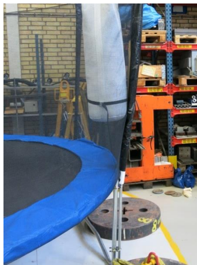
Bild 42 Biltema, Kvarstående deformation på nätstolpe
